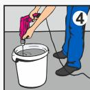
Для подготовки раствора залейте водопроводную воду комнатной температуры в чистую ёмкость из расчёта 0,13-0,16 л воды на 1 кг сухой смеси. Засыпая сухую смесь в воду, перемешивайте раствор дрелью со специальной насадкой на низких оборотах до получения однородной массы. Подождите 5 минут, после этого перемешайте вторично. Время пригодности раствора к работе не менее 60 минут.
