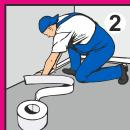
Тщательно заделайте все отверстия и трещины в полу, чтобы предотвратить утечку выравнивающей смеси и усадку затвердевшего пола. По периметру помещения установите изолационный шов с помощью кромочной ленты.
